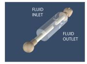
THE MODULE IS SHOWN AT THE BEGINNING OF THE INTAKE STROKE. THE FLAT ON THE VALVE OPENS THE INLET PORT TO THE PUMP CHAMBER AND THE OUTLET PORT IS CLOSED.
