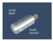
THE PISTON IS SHOWN AT THE BEGINNING OF THE INTAKE STROKE. THE FLAT ON THE PISTON OPENS THE INLET PORT TO THE PUMP CHAMBER AND THE OUTLET PORT IS CLOSED.
